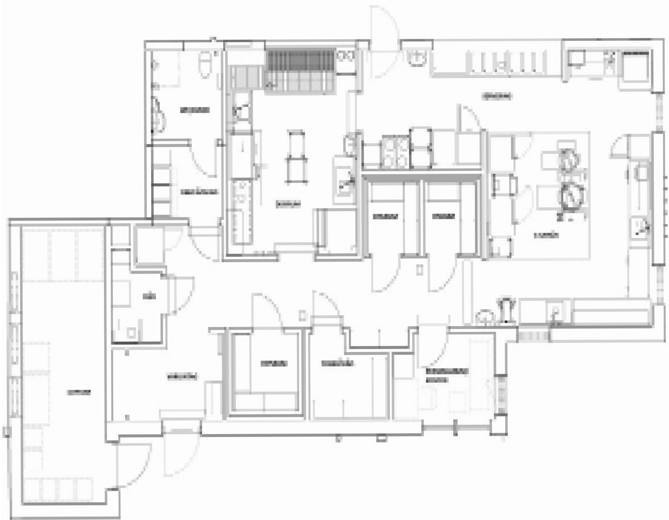
Exempel komposition av kök. Köket är byggt för 175-200 portioner.
