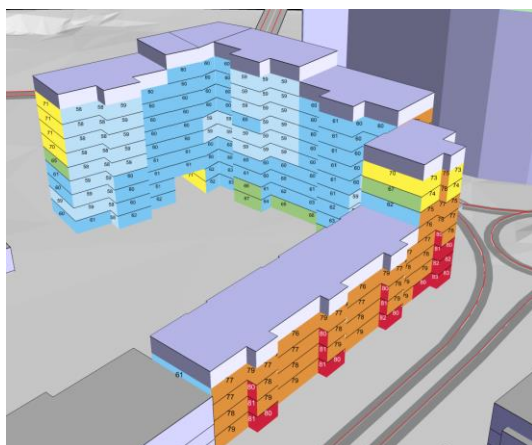
Figur 4. Maximal ljudnivå, frifältsvärde i dBA, utklipp ur bilaga AK05
