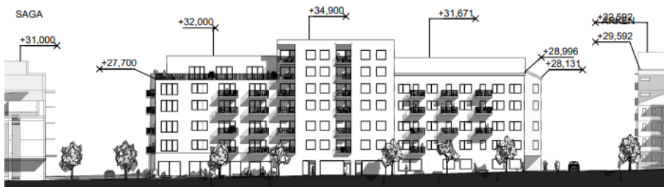
Figur 26 Fasad sedd från öster. Indrag i fasad tillsammans med variation av höjder ska skapa en uppdelning av volymerna samtidigt som förslaget förhåller sig till rutnätsstaden som planstruktur. Bebyggelse mot Arken 12 (6 våningar) regleras med sadeltak för att harmonisera med Arkens volym och takform samt för att mildra påverkan på Arken 10. Källa: Sweco Architects 2024.
