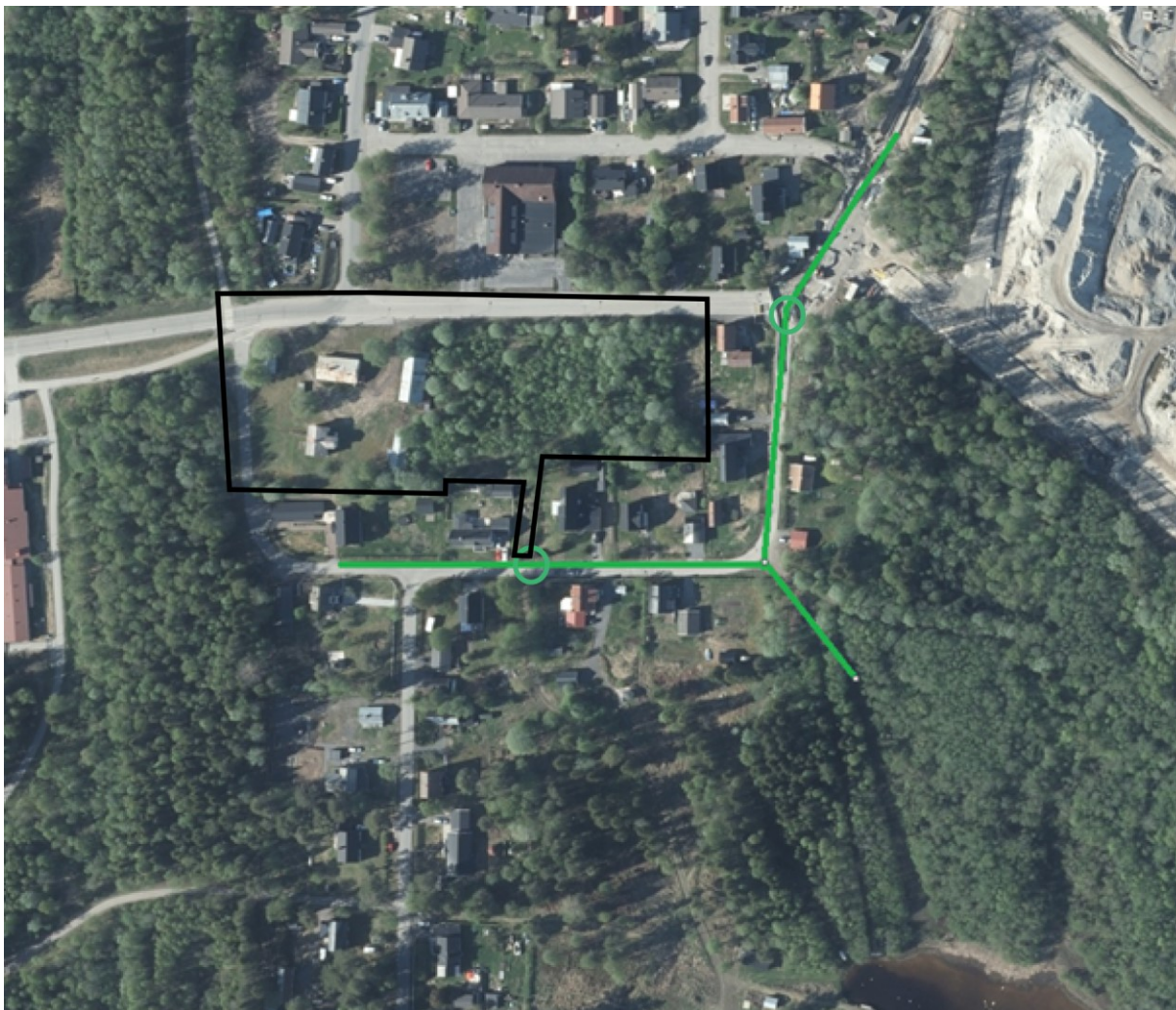
Figur 9. En ungefärlig sträckning över befintligt ledningsnät i anslutning till planområdet. Förslag till anslutningspunkt till ledningsnätet markeras med grön cirkel. Ungefärlig planområdesgräns är markerad med svart.
