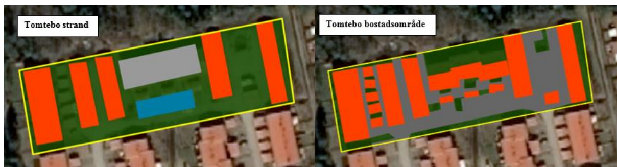
Figur 19. Befintliga markanvändningen för Tomtebo bostadsområde och samma område fast med Tomtebo strands grönare koefficienter. Orange är tak, grått är hårdgjort och grönt är grönyta. Blå markering symboliserar dammvolymer som behövs för att omhänderta dagvattnet.
