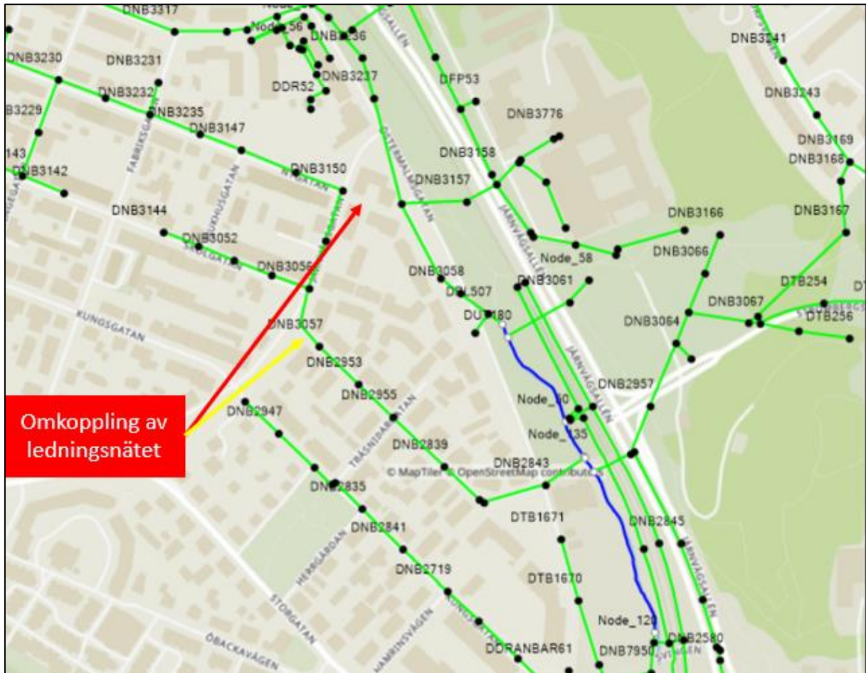
Figur 27: Den röda pilen visar vart en ledning tagits bort och den gula pilen visar vilken ledning som lagts till för att minska trycket på ledningarna uppströms Djupbäckens öppnade del.
