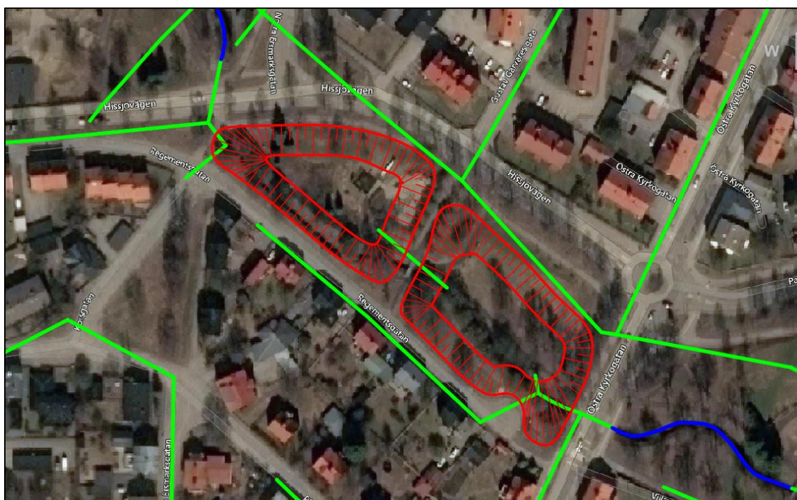
Figur 20: En visualisering i plan av hur mycket fördröjningsvolym som maximalt skulle kunna skapas i åtgärdsförslag 4.
