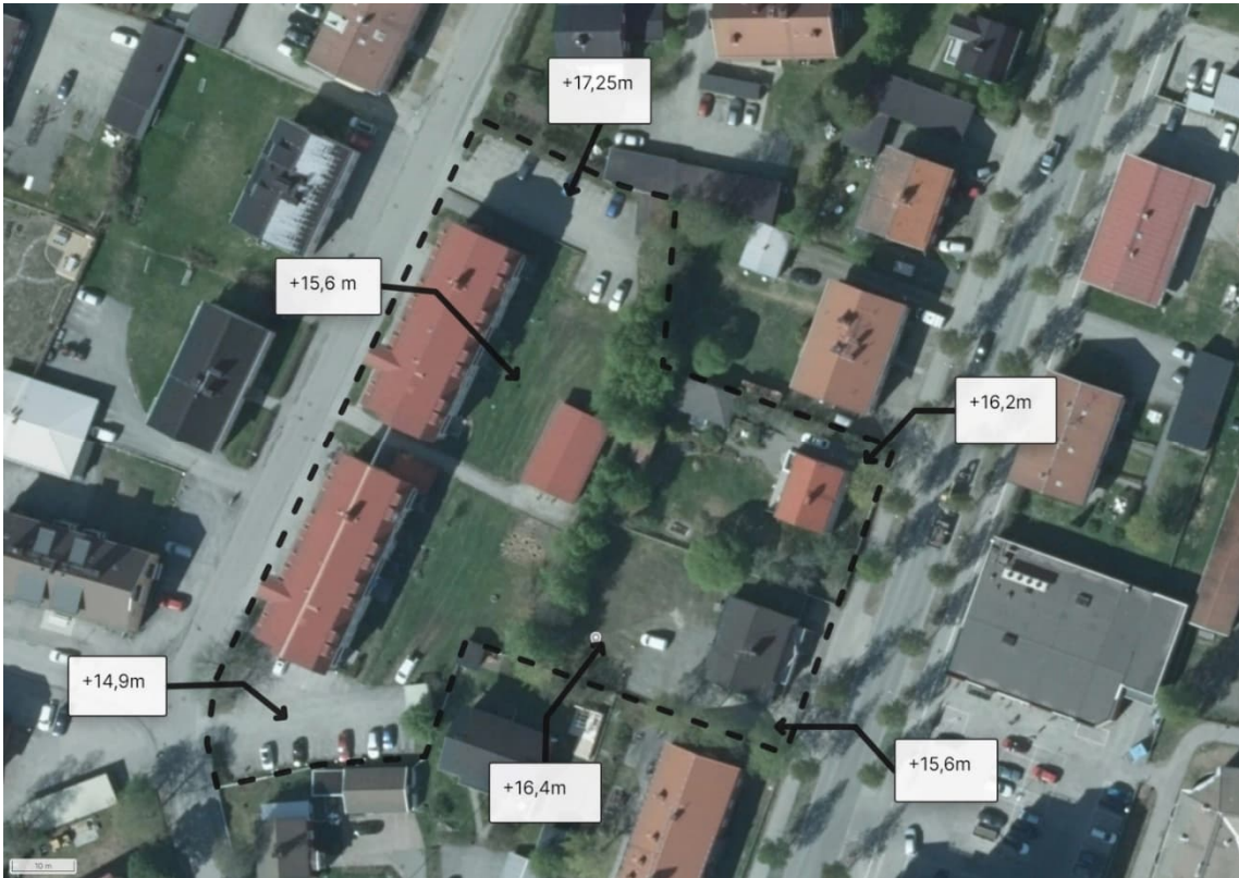
Figur 3. Översiktbild för området med utsatta markhöjder enligt höjddata från Lantmäteriet 2023-07-24 i Scalgo.
