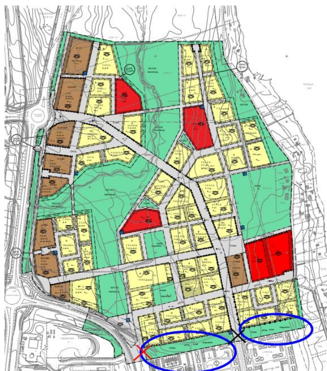
Figur 6 – Blåa ringar markerar omnämnt parkområde Rött kryss markerar anslutning från dike till trumma/ledning Svart kryss markerar passering av dagvattendike mellan Tomtebo strand och Tomtebo
