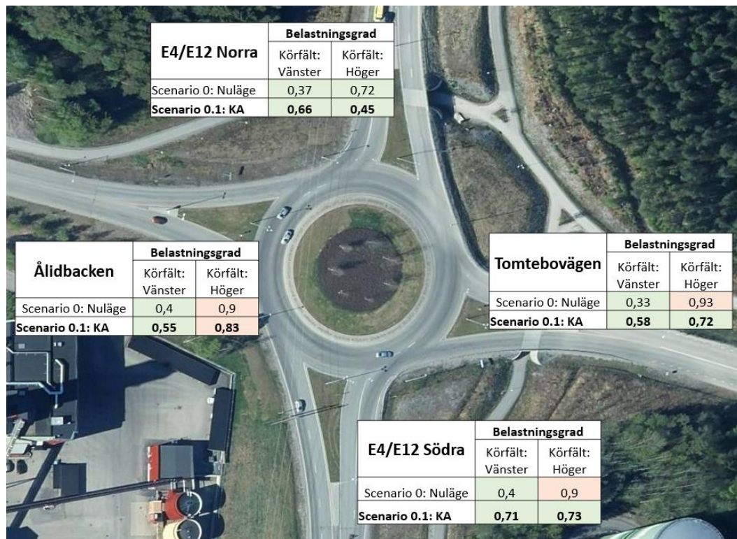
Figur 3-5 Beräknade belastningsgrader under eftermiddagens maxtimme för nuläget samt för känslighetsanalysen med jämna flöden mellan anslutande körfält för genomgående trafik (fetmarkerade siffror).
