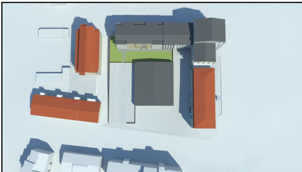
Figur 27. Exempel på friytans storlek och placering vid en exploatering med 1400 BTA bostäder.
